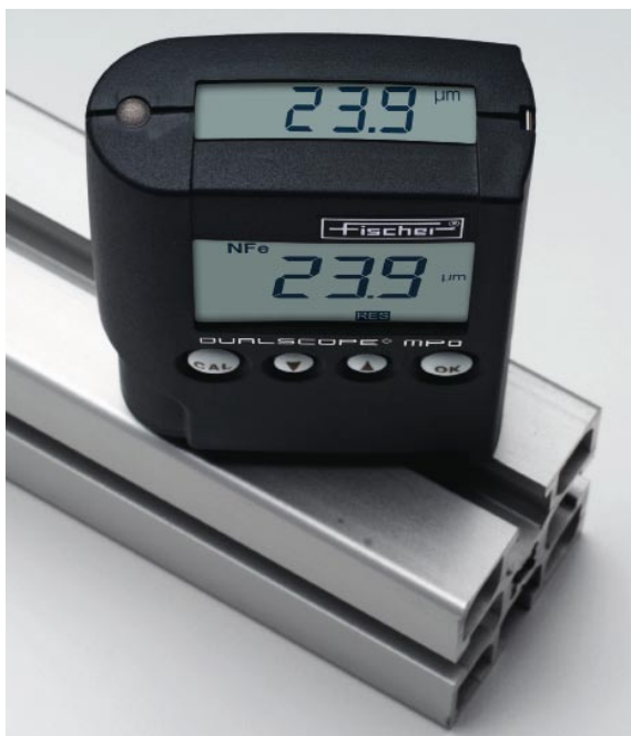
测量铝上阳极氧化膜的厚度
